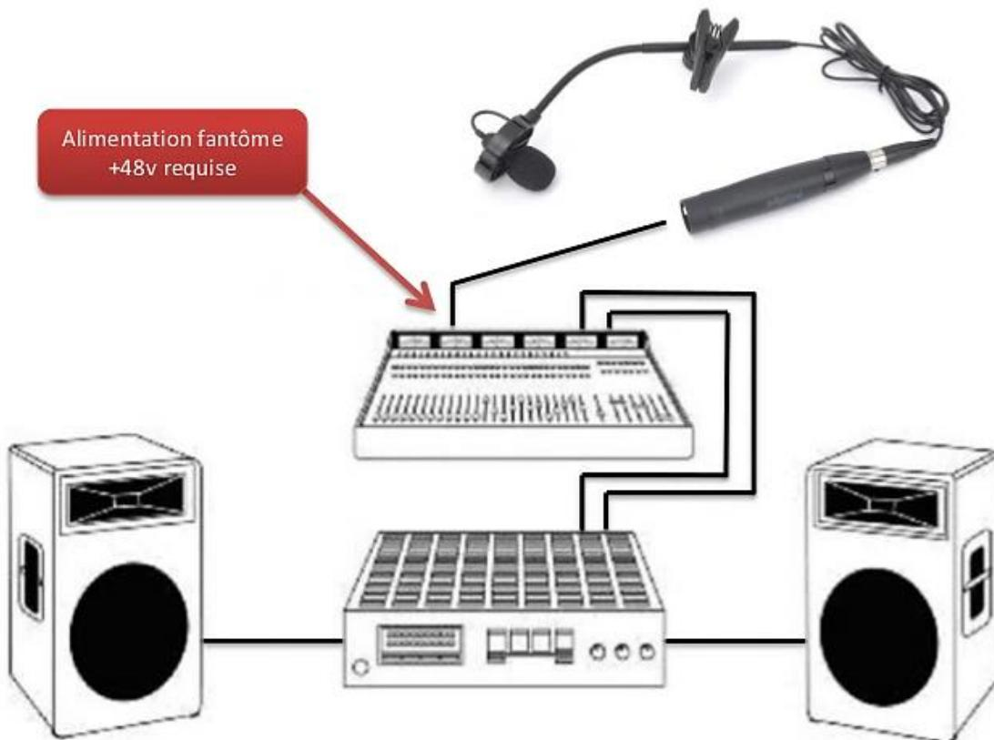
Connectez la fiche mini XLR du micro série 21 Lanen à l'adaptateur mini XLR/XLR. A l'aide d'un cordon XLR/XLR (non fourni) connectez votre micro à une console de mixage ou à tout équipement disposant d'une entrée audio XLR avec alimentation fantôme +48v.
