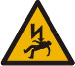
Le symbole de l'éclair finissant sur un personnage à l'intérieur d'un triangle équilatéral est destiné à sensibiliser l'utilisateur au fait que des « tensions électriques dangereuses » non isolées sont présentes à l'intérieur de l'appareil et qu'elles peuvent être suffisamment importantes pour constituer un risque d'électrocution.
