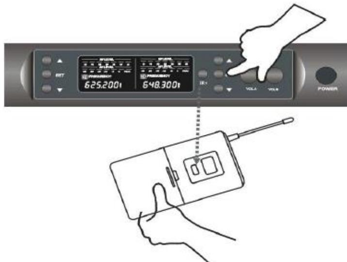
Dans le cas des modèles DSP DUO UHF avec deux microphones M850 ou deux bodypacks B210 vous devez procéder de la même manière avec chaque microphone ou bodypack pour les synchroniser.
