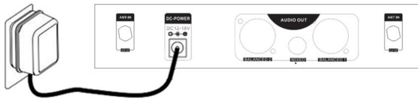
Connectez l'adaptateur secteur à l'arrière du récepteur (à l'emplacement prévu à cet effet) et à une prise de courant : 230V/50 Hz.
