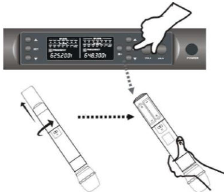
Réalisez un appui long sur le bouton "DOWN" [ $\nabla$ ] afin de lancer la recherche automatique des fréquences, une fois la fréquence sélectionnée, faites un appui court sur le bouton [SET] pour valider, puis un second appui court pour appairer l'émetteur avec le récepteur. Laissez les deux appareils se synchroniser, lorsque le voyant du récepteur s'allumera en vert, la synchronisation automatique sera terminée.
