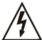
Le symbole de l'éclair finissant par un flèche à l'intérieur d'un triangle équilatéral est destiné à sensibiliser l'utilisateur au fait que des « tensions électriques dangereuses » non isolées sont présentes à l'intérieur de l'appareil et qu'elles peuvent être suffisamment importantes pour constituer un risque d'électrocution.
